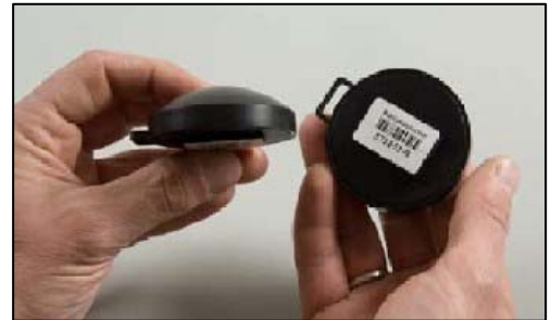
Radonmeetbeker van het type dat in de derde radon-survey is gebruikt
